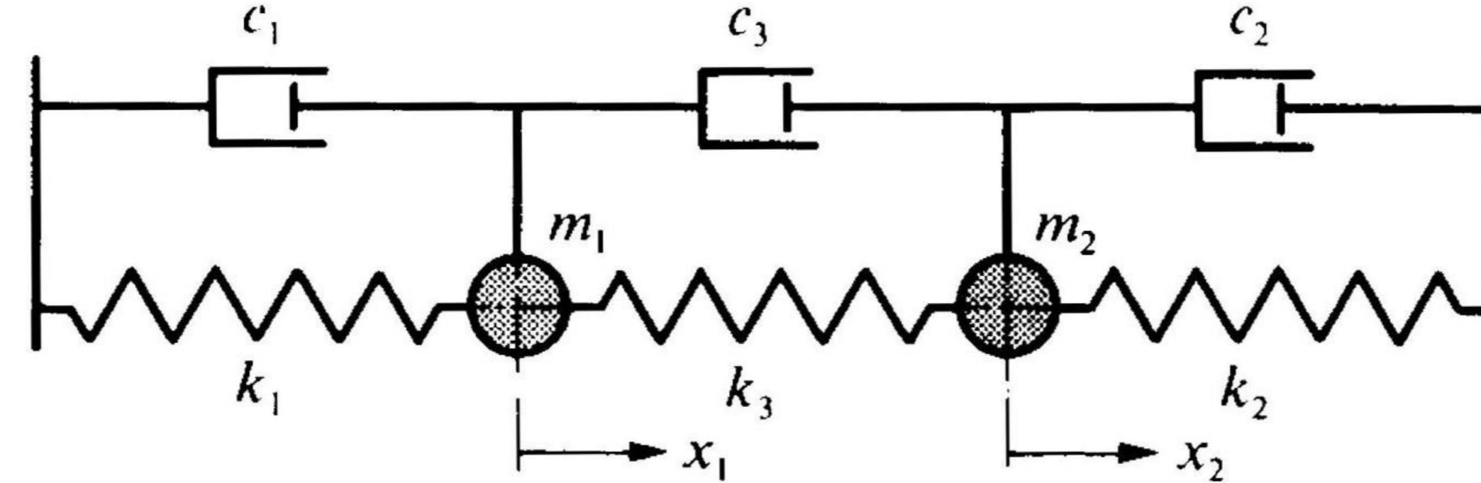
*Fonction de dissipation de Rayleigh du système à deux degrés de liberté*
